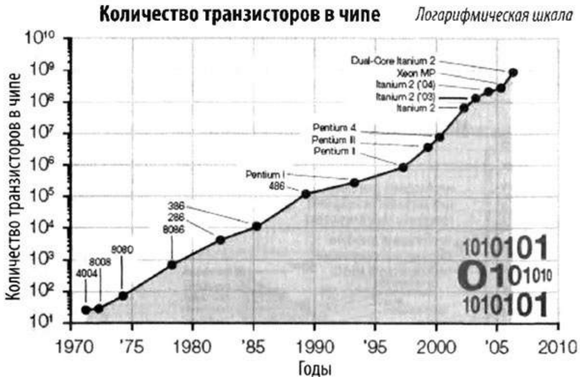
Количество транзисторов в чипе для различных процессоров Intel.
